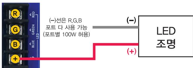
딤스위치 1,2,3번 핀을 ON 시킨 후 LED조명을 위 그림처럼 출력단자에 연결합니다. (-)전기는 BLUE / GREEN / RED 3가지 포트 모두 사용 하실 수 있으며, 각각 W(용량)은 100W까지 연결하여 사용이 가능합니다. 이 후 밝기조절 롤링핀으로 조절합니다.
